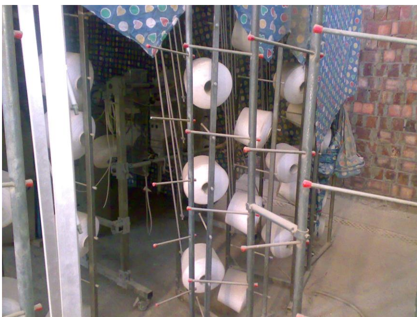
ماكينه تريكو دائرية (Lorizo) electronic single knit circular قطعة واحدة
