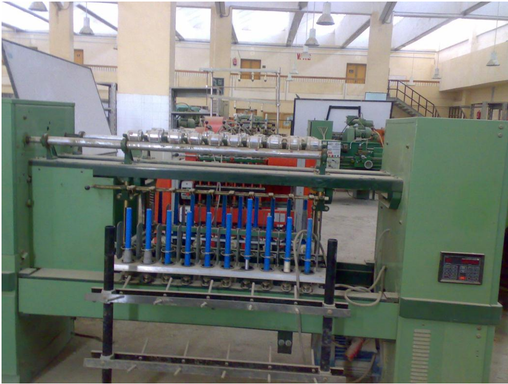
ماكينة الزوى Doubling / twisting machine
